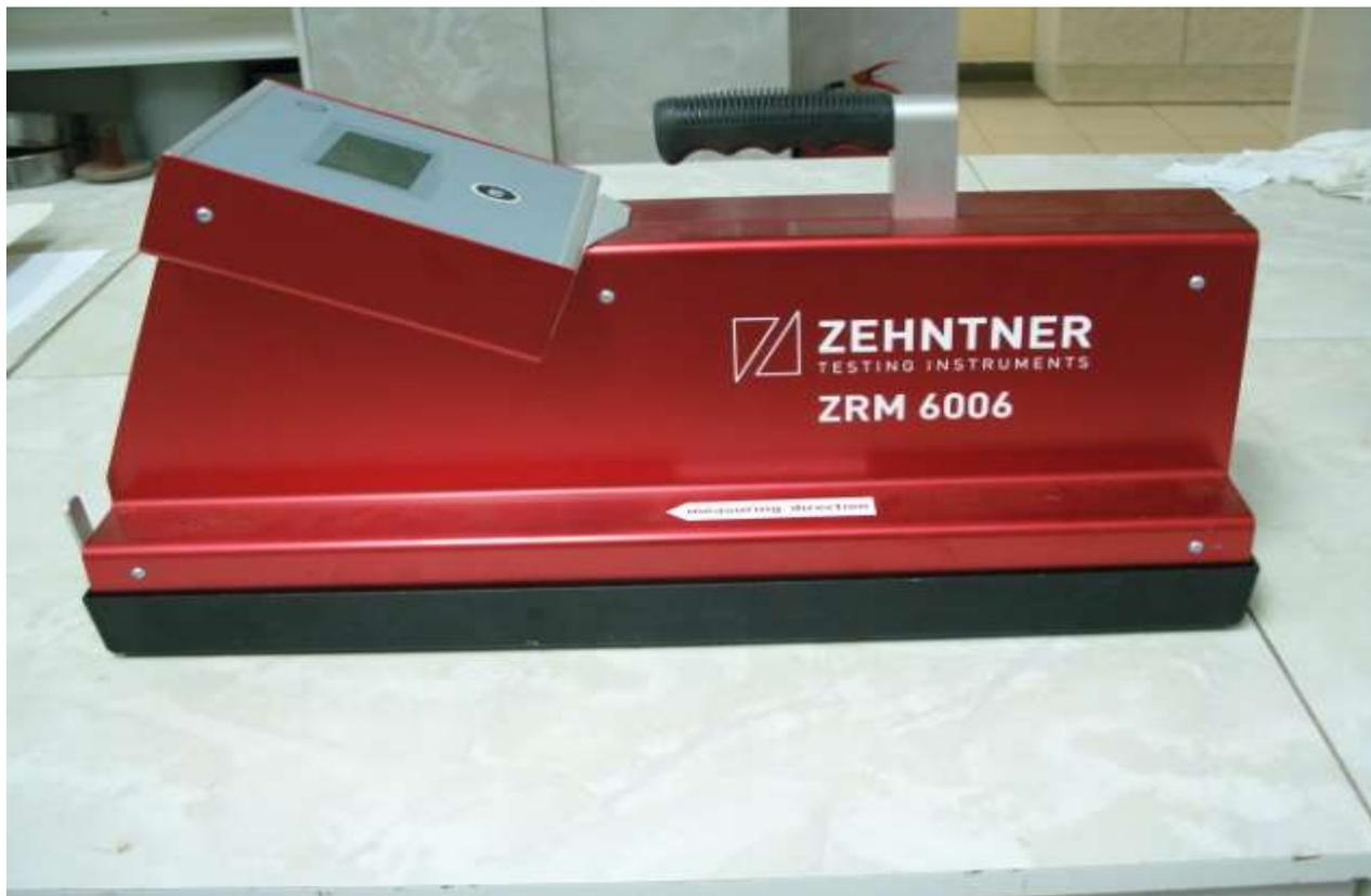
Рис. 1. Ретрорефлектометр ZRM 6006.
