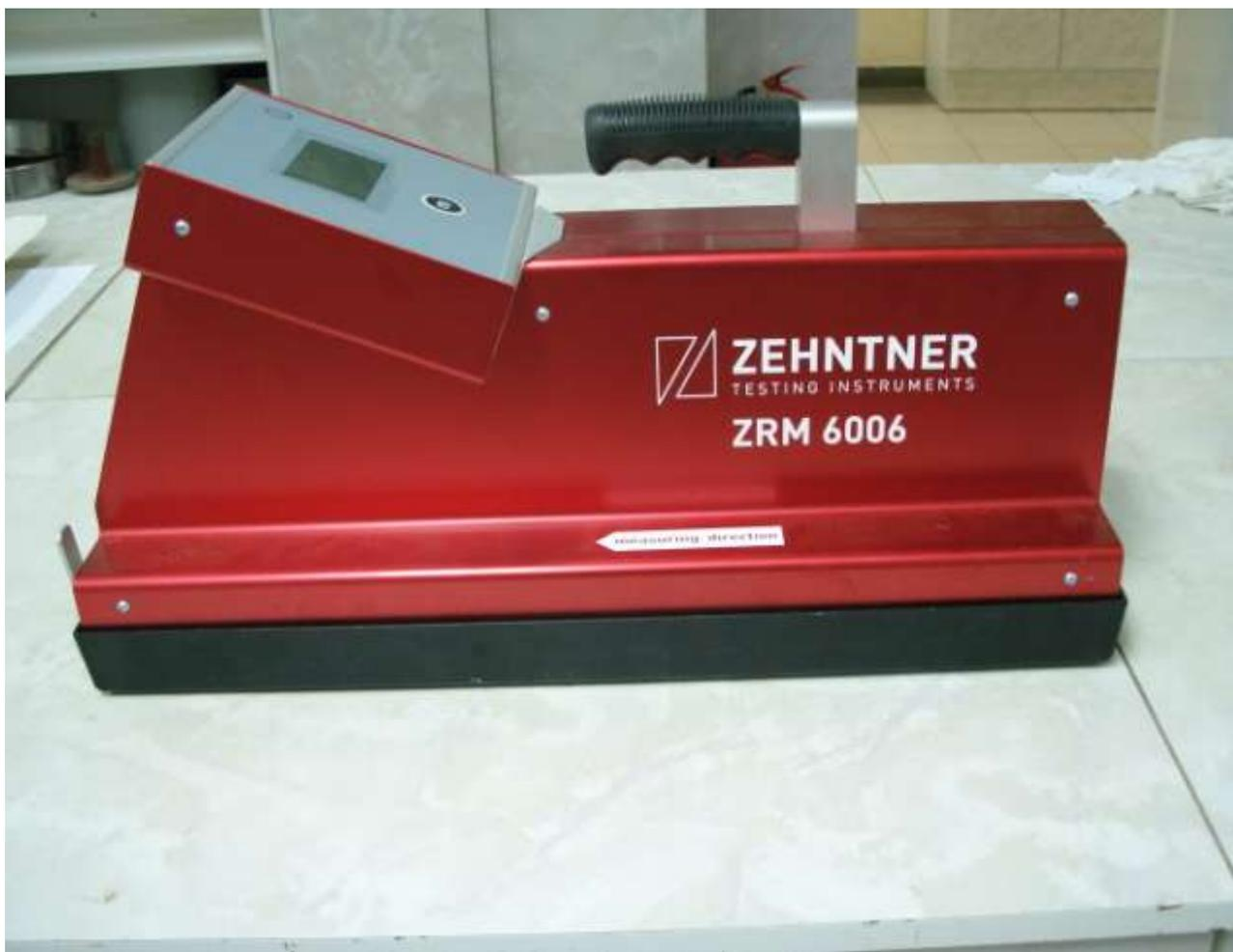
Рис. 1. Ретрорефлектометр ZRM 6006.
