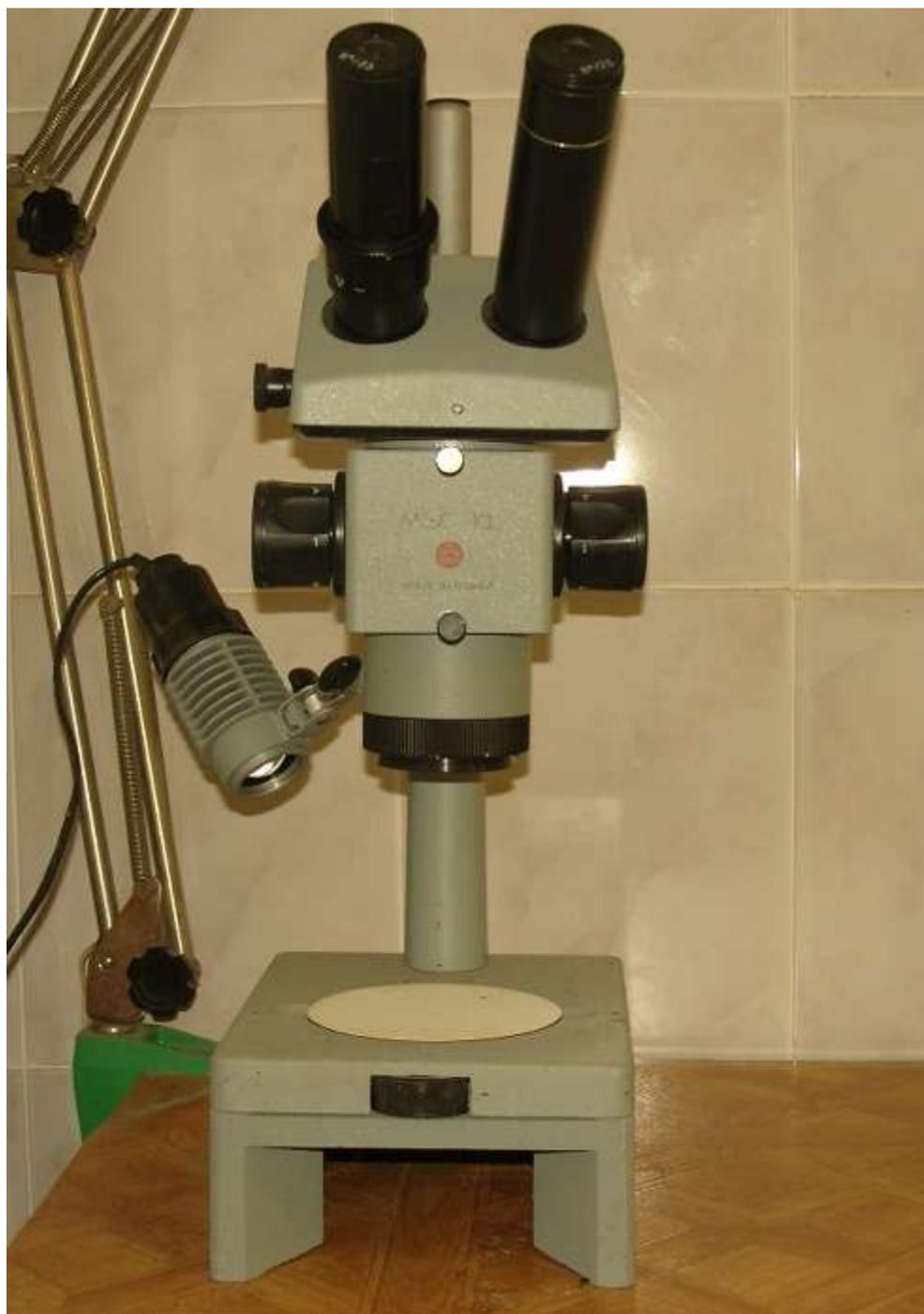
Рис. 1. Стереоскопический бинокулярный микроскоп МБС-10.
